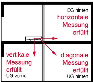
Prüfstand mit Prüfaufbau und Messräumen. Die höchste Anforderungsstufe an den Schallschutz wird in jede Messrichtung erfüllt.
